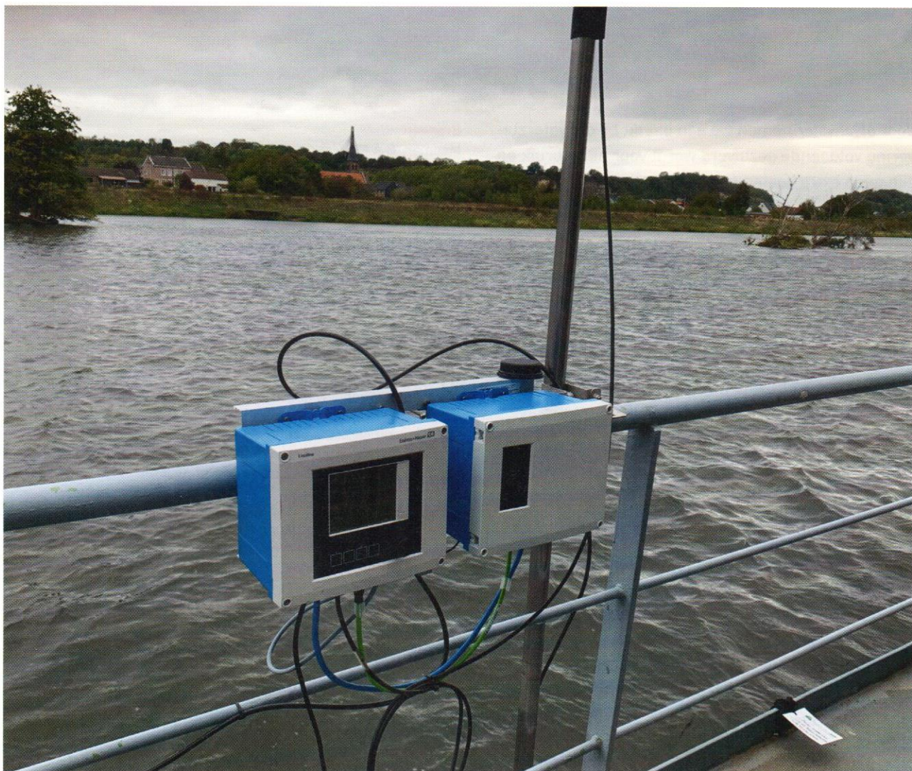
Foto 1: De Maas bij Eijsden gezien vanaf het meetplatform. De meeste sensoren zijn aan de reling bevestigd en direct in de Maas geplaatst
